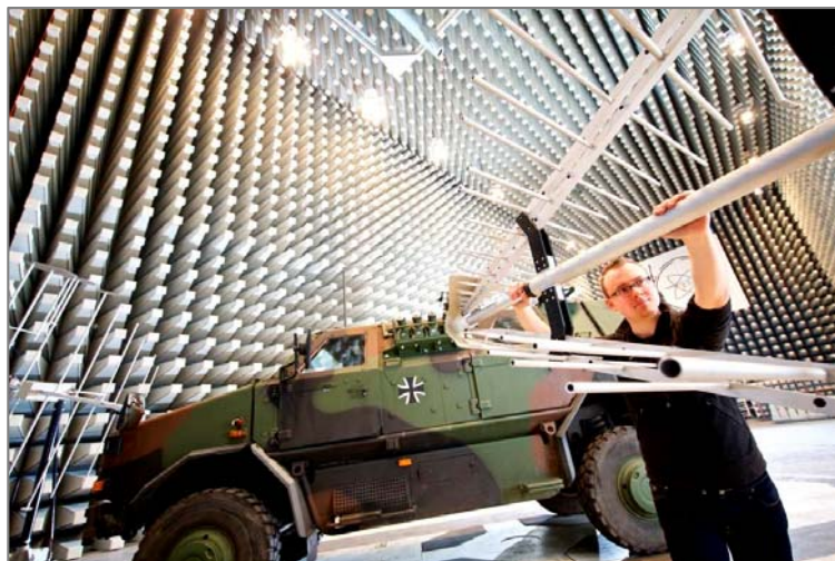
Untersuchungen zur Elektromagnetischen Verträglichkeit (EMV) am Dingo 2 in der EMV-Halle der Wehrtechnischen Dienststelle für Informationstechnologie und Elektronik, Greding (Quelle: Bundeswehr/WTD 81)
