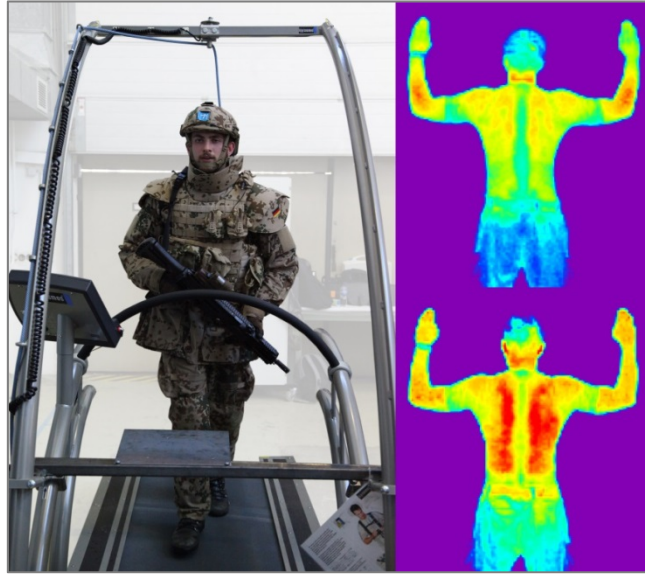
Tragekomfort im Blick – Erprobung der neuen Kampfbekleidung Einsatz/Übung Links: Proband beim Absolvieren des Laufprofils, rechts: vergleichende Thermographieaufnahmen vor und nach Belastung (Quelle: Bundeswehr/WTD 91)
